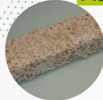
Ce projet a proposé d'étudier la faisabilité d'obtenir un matériau à transition de phase microencapsulé et biosourcé par séchage d'émulsions. La stratégie adoptée est basée sur la fabrication et l'atomisation d'émulsions stabilisées par des particules solides amphiphiles, et n'implique pas de solvants organiques. Les particules et la phase encapsulée seront issues de biomasses peu valorisées et peu transformées (coproduits agricoles et huiles).
