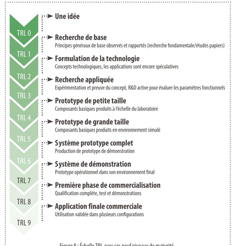
Figure 8 : Échelle TRL avec ses neuf niveaux de maturité
